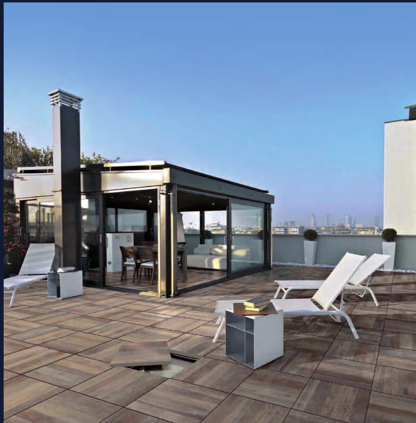
Dalle Grès Cérame 60 x 60 cm en 20 mm d'épaisseur pour un usage extérieur.
